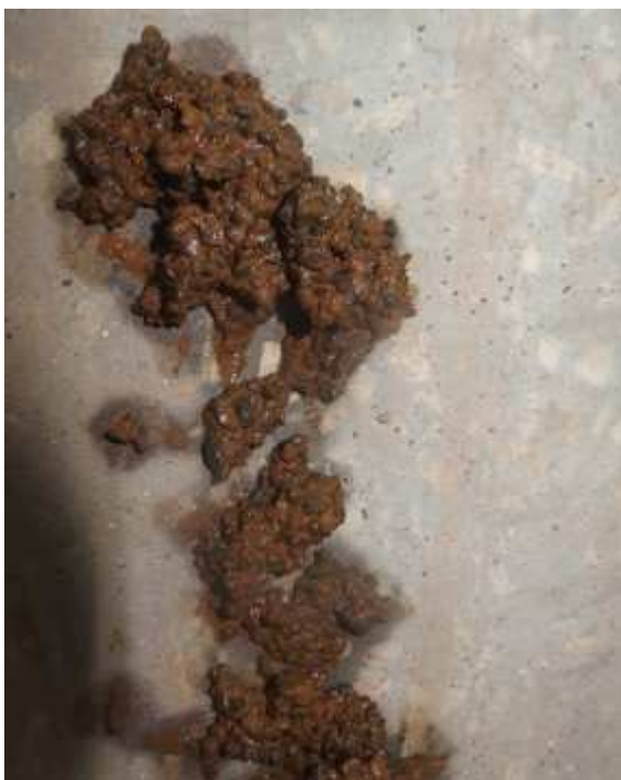
Zdjęcie 9. Złoże filtracyjne z Filtra nr 4 - odmanganiaczu (bezpośrednio po poborze i po wyschnięciu)
