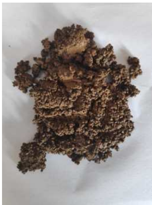
Zdjęcie 9. Złoże filtracyjne z Filtra nr 4 - odmanganiaczu (bezpośrednio po poborze i po wyschnięciu)
