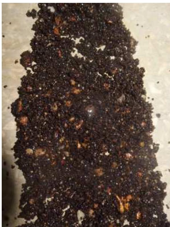
Zdjęcie 7. Złoże filtracyjne z Filtra nr 3 - odżelaziacza (bezpośrednio po poborze i po wyschnięciu)
