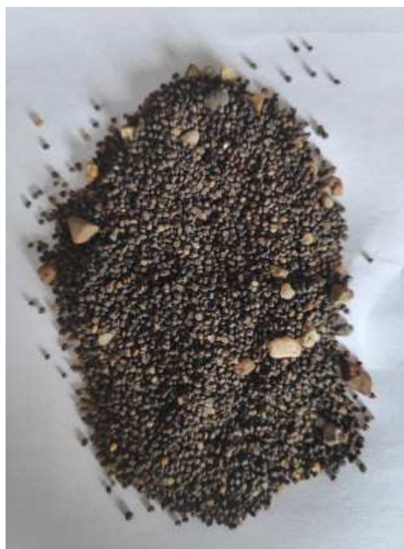
Zdjęcie 7. Złoże filtracyjne z Filtra nr 3 - odżelaziacza (bezpośrednio po poborze i po wyschnięciu)
